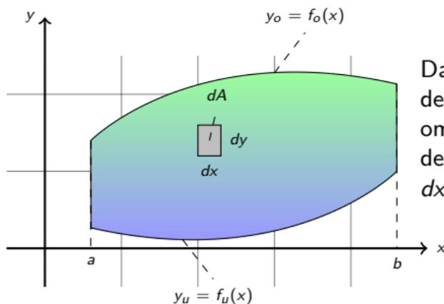
Das *Flächenelement*  $dA$  besitzt in der kartesischen Darstellung die geometrische Form eines *Rechtecks* mit den infinitesimal kleinen Seitenlängen  $dx$  und  $dy$ . Somit ist
