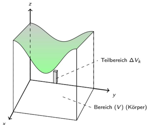
Zylindrischer Körper mit der "Deckelfläche"
