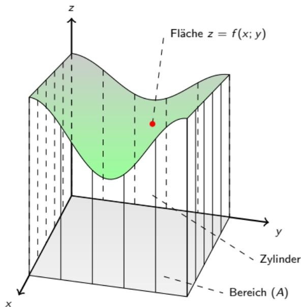
Zylindrischer Körper mit der "Deckelfläche"
