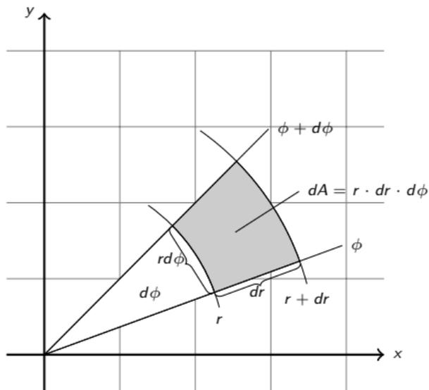
Das *Flächenelement*  $dA$  wird in der Polarkoordinatendarstellung von zwei infinitesimal benachbarten *Kreisen* mit den Radien  $r$  und  $r + dr$  und zwei infinitesimal benachbarten *Strahlen* mit den Polarwinkeln  $\phi$  und  $\phi + d\phi$  berandet.
