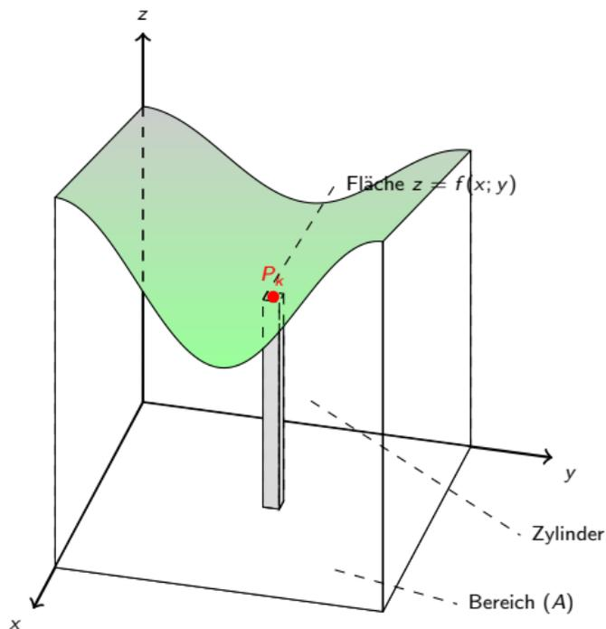
Zylindrischer Körper mit der "Deckelfläche"
