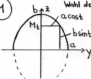
Wahl des KS: Ursprung in Grundkreismittelpunkt, z-Achse  $\hat{=} \text{Symmetrieachse}$
