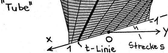
Fazit: t-Linien: Geradenstücke (parallel  $(y, z)$ -Ebene), p-Linien: Ellipsen um die z-Achse
