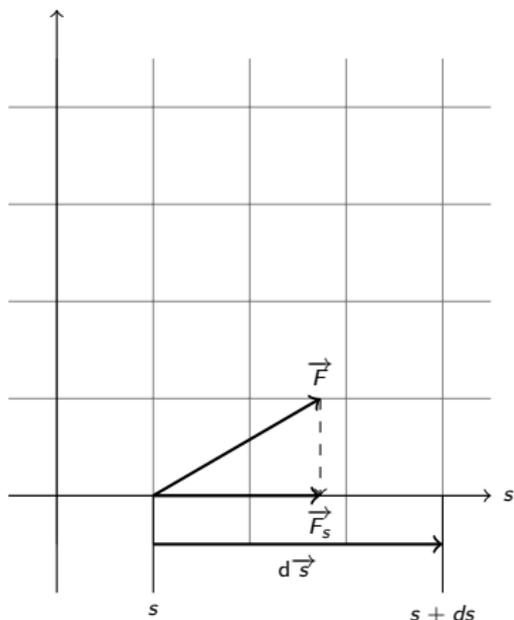
**Verschiebung längs einer Geraden durch eine ortsabhängige Kraft**
