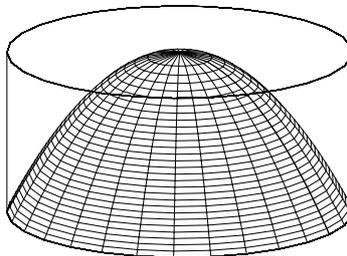
Es sei  $V_Z$  das Volumen eines gegebenen Kreiszyinders,  $V_P$  das Volumen desjenigen Rotationsparaboloids, das mit diesem Zylinder Grundfläche und Höhe gemeinsam hat. Dann gilt
