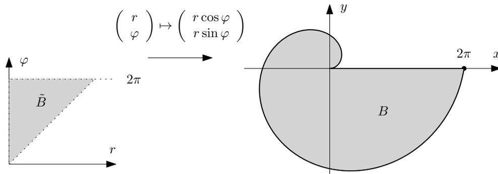
entspricht dieser Bereich  $B$  offenbar  $\tilde{B} = \{(r, \varphi) \in (0, \infty) \times (0, 2\pi) \mid 0 < r < \varphi\}$ .
